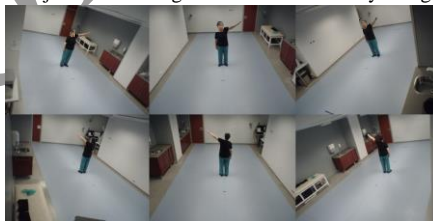
Figura 1. Grabación del sujeto desde 3 ángulos de visión frontal y 3 ángulos de visión posterior
